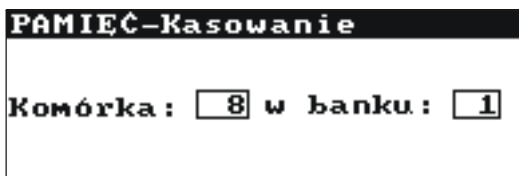
Rys.11. Kasowanie komórki pamięci: 1 – nr banku, 8 – nr komórki, 1 – bank z co najmniej jedną zajętą komórką, 8 – komórka zajęta
